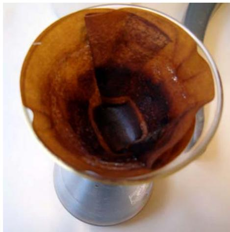
*Fig. 14 Depósito de la masa sólida sobre el papel de filtro.*
