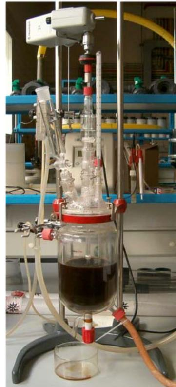
*Fig. 10 Reactor de mezcla perfecta sin aireación.*
