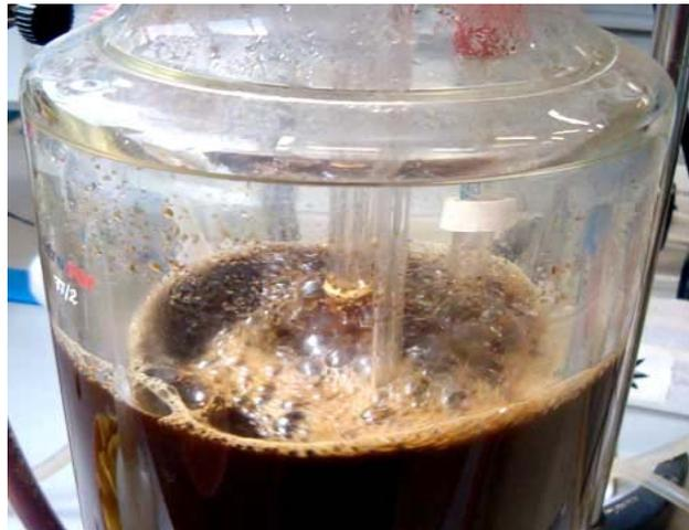
*Fig. 8 Formación de espumas causada por la aireación.*
