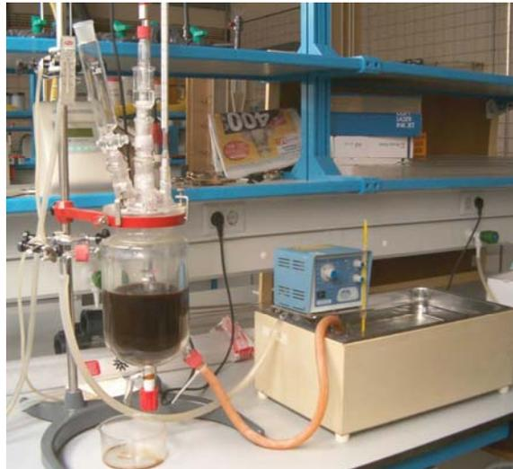
*Fig. 7 Reactor y baño térmico.*
