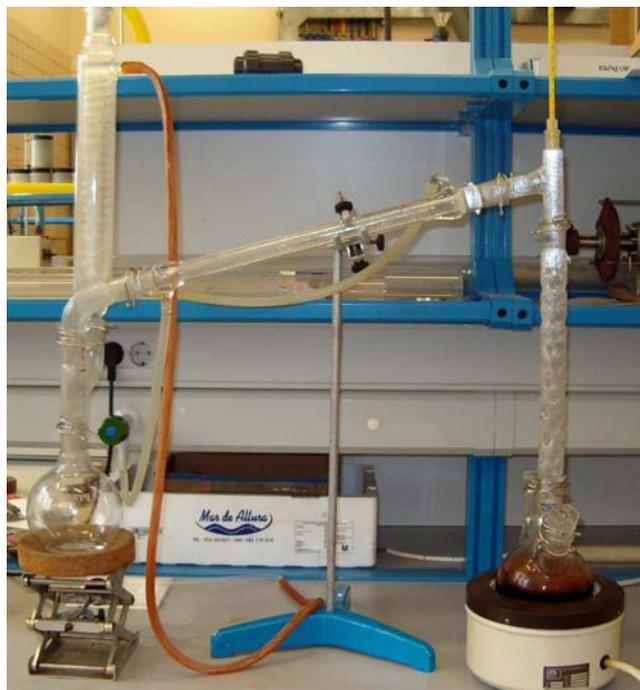
*Fig. 12 Columna de destilación.*
