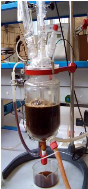
*Fig. 9 Reactor de mezcla perfecta con aireación*
