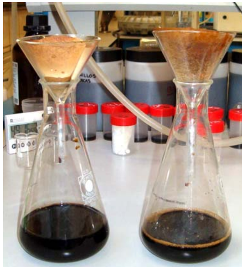
Fig. 13 Filtrado de la fase densa del producto de reactor.
