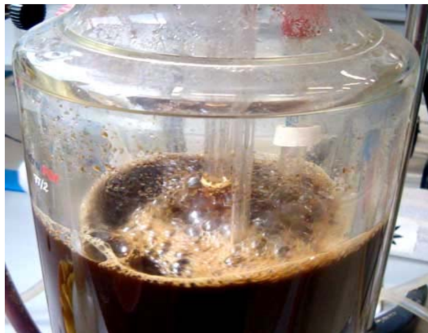
Fig. 8 Formación de espumas causada por la aireación.
