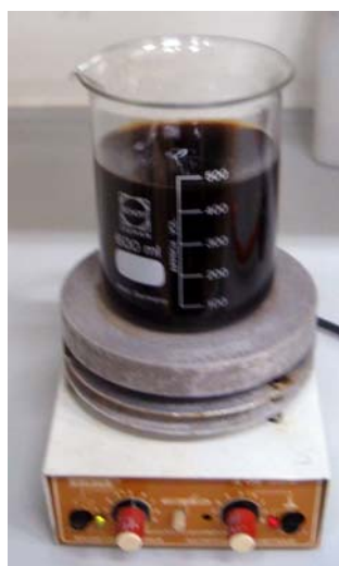
Fig. 3 Homogenización de la mezcla
