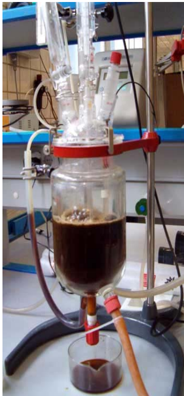
Fig. 9 Reactor de mezcla perfecta con aireación
