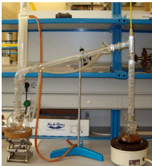
Fig. 12 Columna de destilación.
