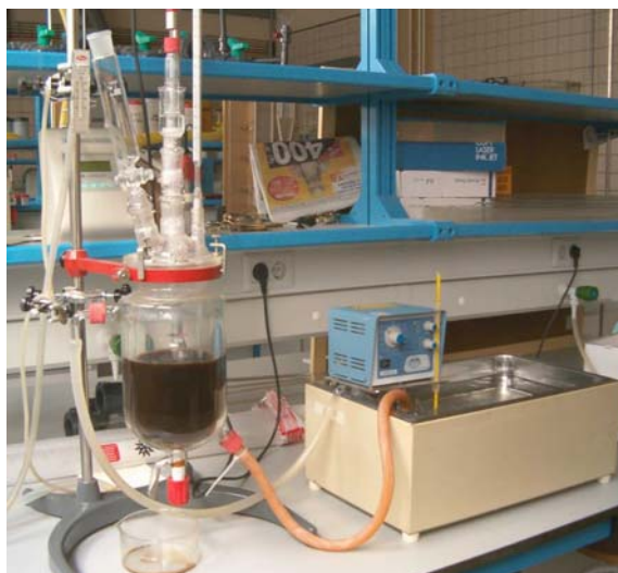
Fig. 7 Reactor y baño térmico.
