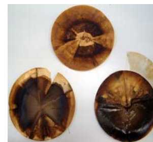
Fig. 18 Comparación de la masa filtrada entre los sustratos sometidos a la fermentación y el sustrato fresco.
