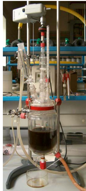
Fig. 10 Reactor de mezcla perfecta sin aireación.
