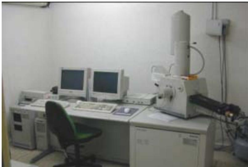
Figura 3.4 Microscopio electrónico de barrido PHILIPS XL-30 empleado para el análisis morfológico de las partículas.
