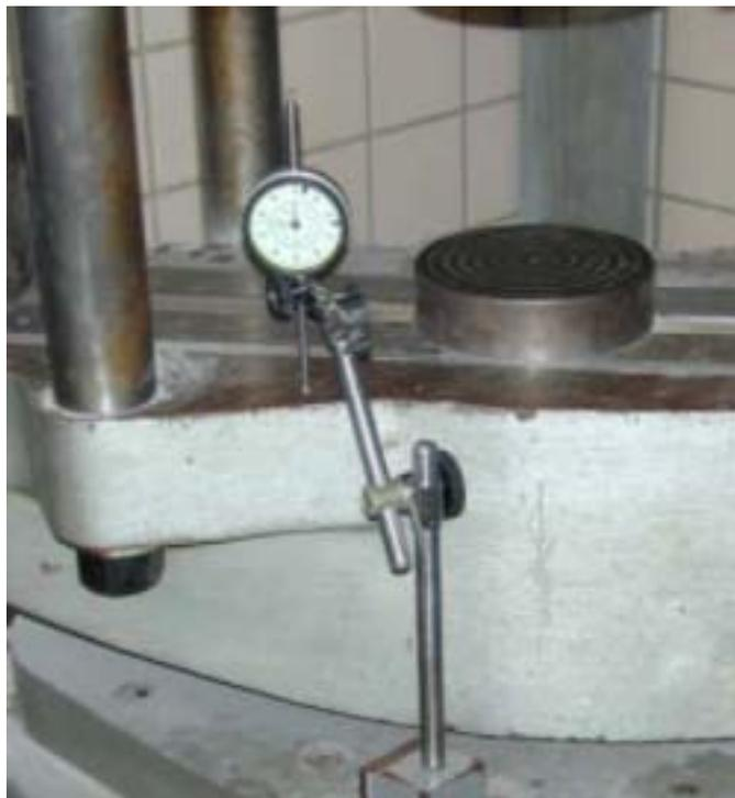
Figura 3.2 Reloj comparador empleado para obtener la curva de compresibilidad
