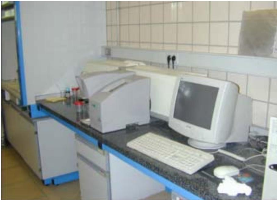
Figura 3.3 Mastersizer 2000 empleado para obtener la granulometría
