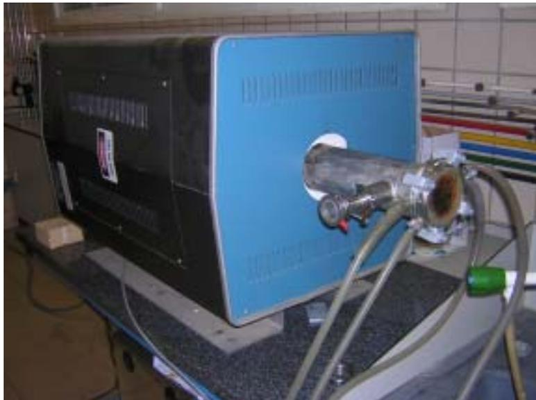
Figura 3.10 Horno de tubo de acero horizontal, LINDBERG
