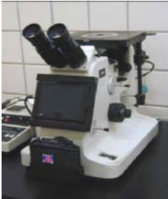
Figura 3.5 Microscopio óptico NIKON EIPHOT modelo 200 empleado para caracterización microestructural de los materiales.
