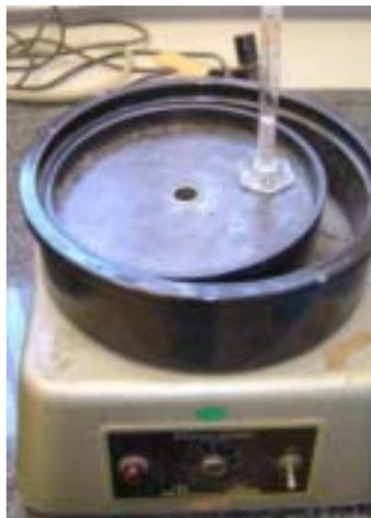
Figura 3.1 Vibrador y probeta graduada
