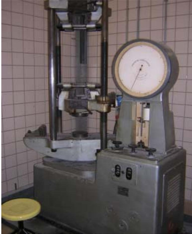
Figura 3.9 Máquina de ensayos universal MALICET ET BLIN U-30
