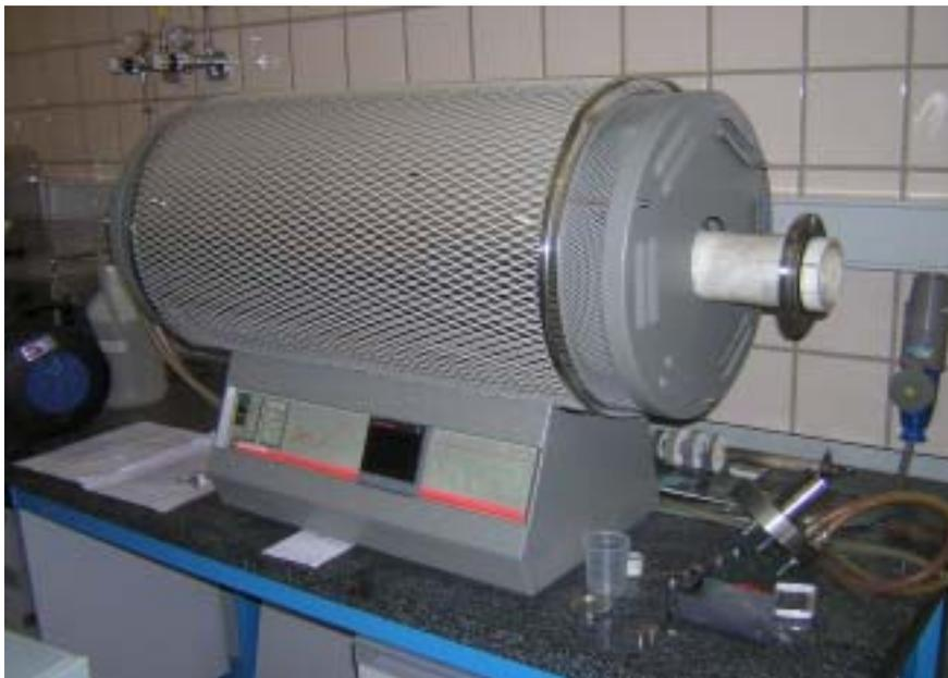
Figura 3.12 Horno tubo horizontal cerámico CARBOLYTE
