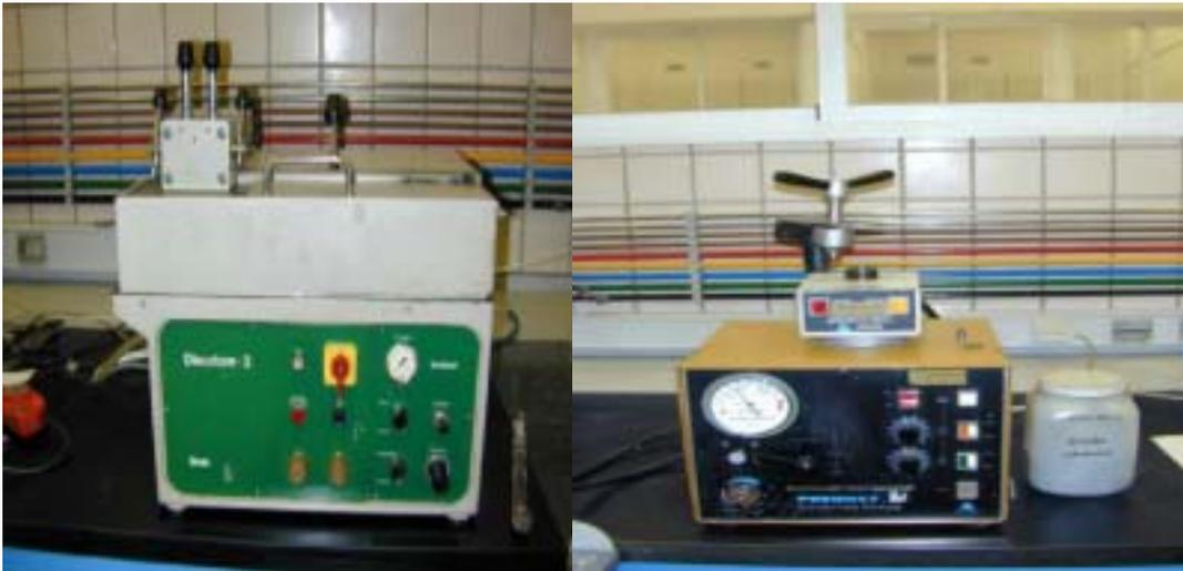
Figura 3.15 maquina de corte    Figura 3.16 maquina de empastillado
