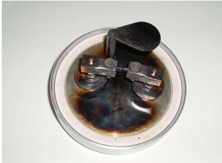
Figura 4.4: Detalle de la cabeza metalizadora
