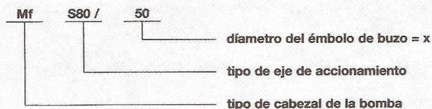
Ejemplo para una bomba de membrana de acero inoxidable de doble cabezal:
