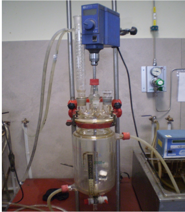
Figura 7.1. Reactor de vidrio encamisado con refrigerante y motor eléctrico.
