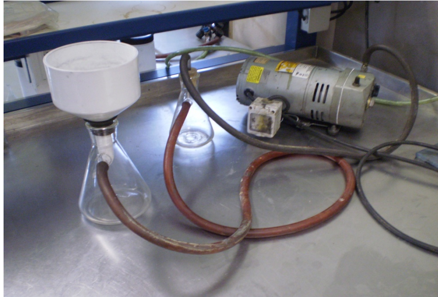
Figura 7.2. Equipo de filtración a vacío.
