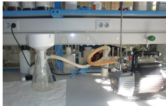
Ilustración II-2. Equipo de filtración.
