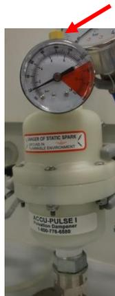
Ilustración III-16. Amortiguador de pulsos.
