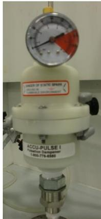
**Ilustración III-8. Amortiguador de pulsos ACCU-PULSE.**
