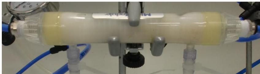
**Ilustración III-4. Módulo de membranas Liquid-Cel empleado.**
