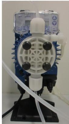
Ilustración III-6. Bomba del circuito de acuoso.
