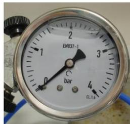
Ilustración III-11. Manómetro (EN837-1).
