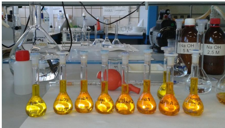
Ilustración I-2. Muestras a las que se les ha aplicado el método colorimétrico para la determinación de Ge.
