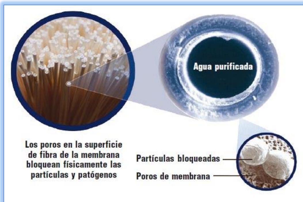
Figura 1: Zoom capilares de membranas de fibra hueca.
