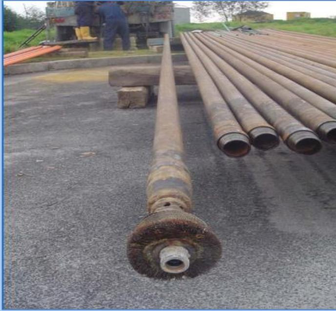
Figura 7: Gratas de cepillos para limpieza de pozos de extracción.
