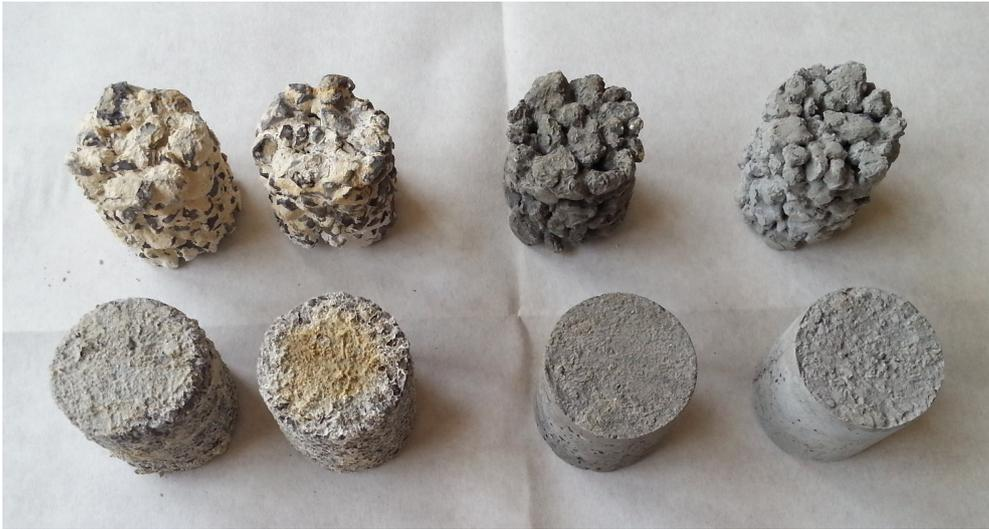
**Figura 5.3.15: Probetas tras 14 días de inmersión. A la derecha las probetas inmersas en agua; a la izquierda las probetas inmersas en ácido.**
