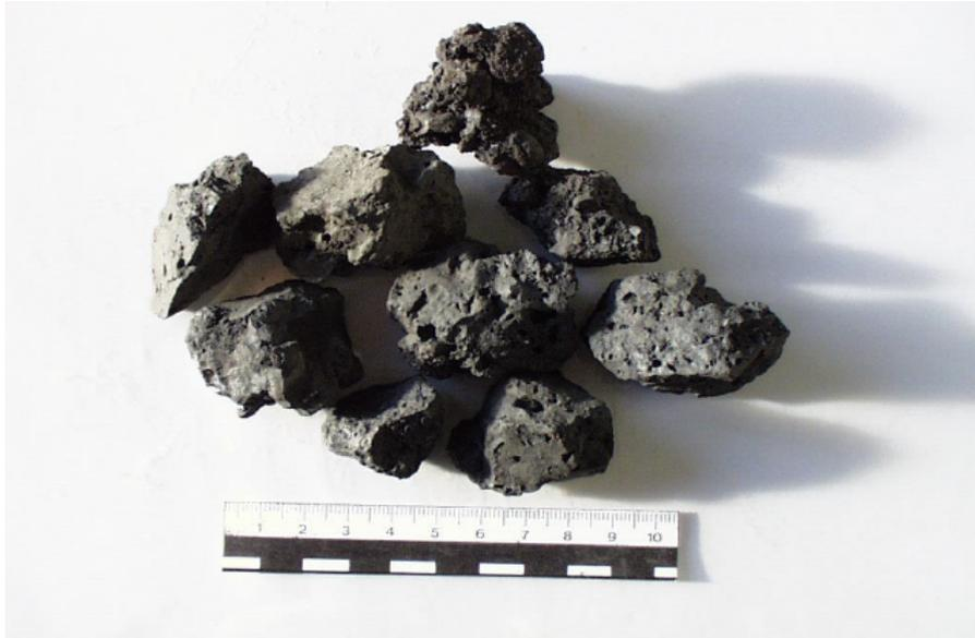
**Figura 1.2.1: Escoria negra de acería de horno de arco eléctrico.**
