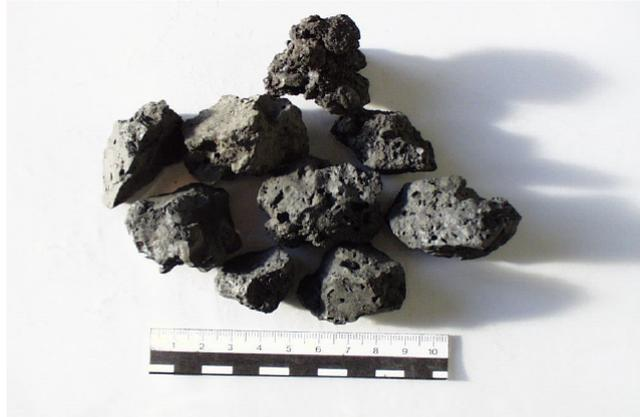
**Figura 4.1.1: Escoria negra de acería de horno de arco eléctrico.**
