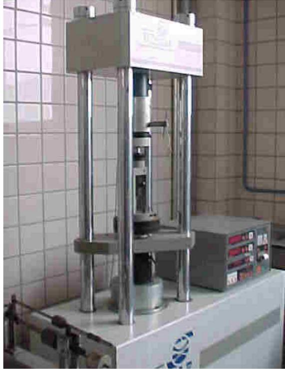
**Figura 4.2.2: Equipo usado en la determinación de la resistencia a compresión.**
