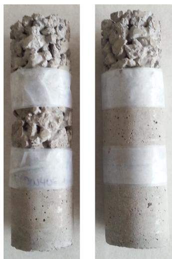
**Figura 5.3.13: Combinación de las probetas ensayadas acústicamente. A la izquierda la combinación BBA, a la derecha la combinación BAA.**
