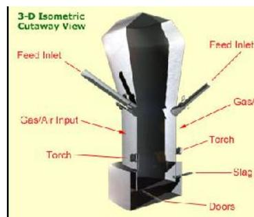
Figura 6 Reactor Gasificación Plasma
