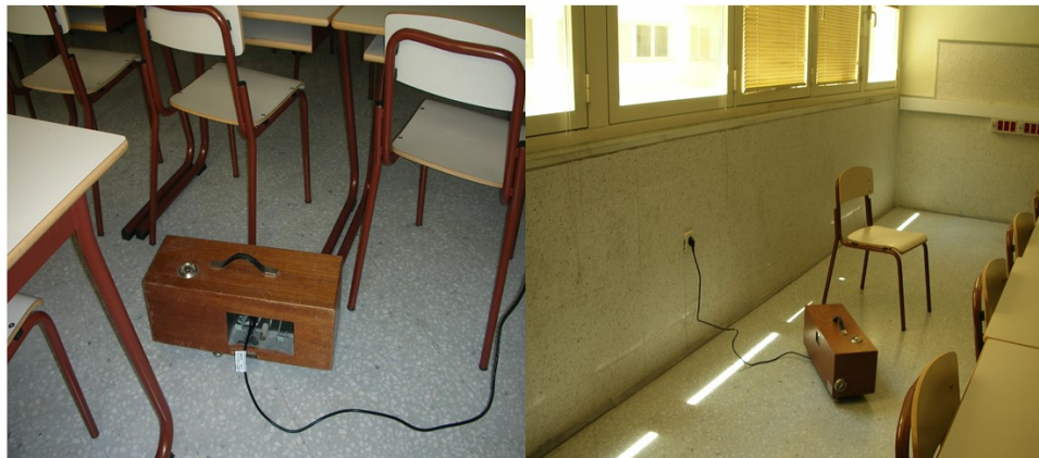
Figura 4. Máquina de impactos en distintos puntos
