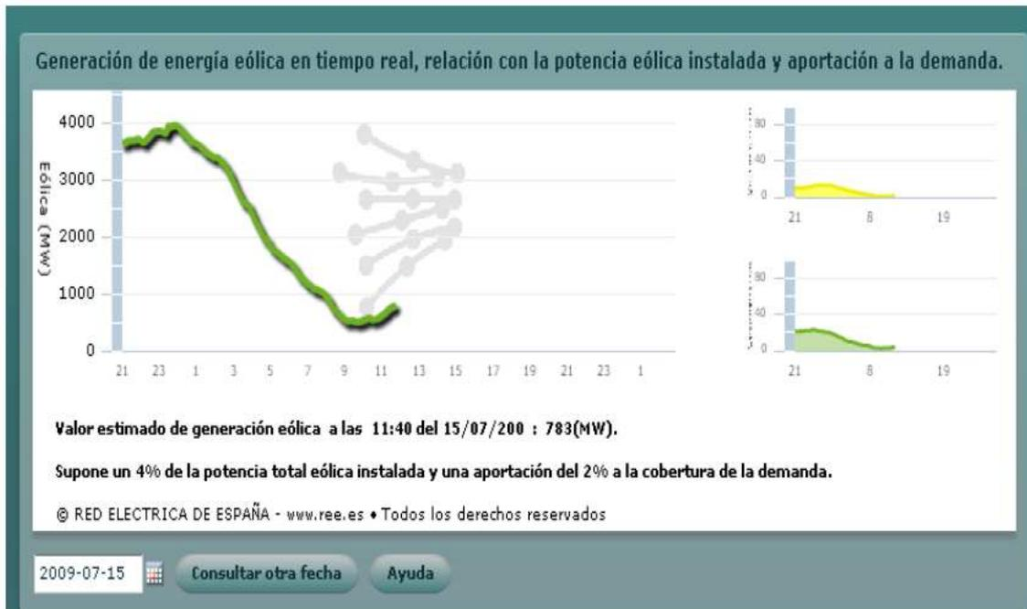
Figura 105: Ejemplo de Generación Eólica de poco viento. Fuente: Red Eléctrica Española.
