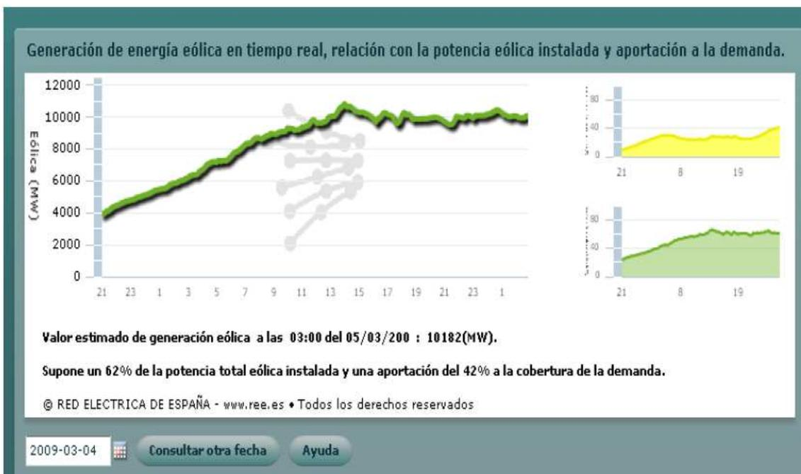
Figura 106: Ejemplo de Generación Eólica de bastante viento. Fuente: Red Eléctrica Española.
