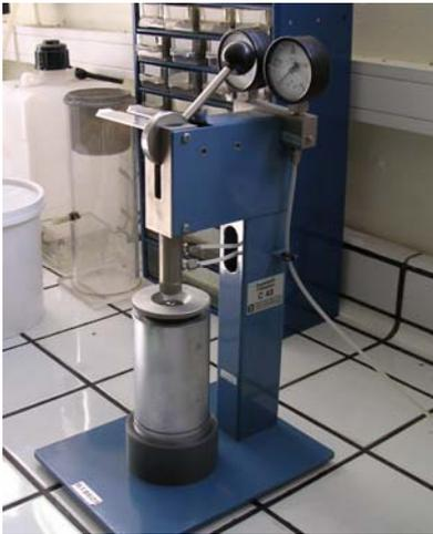
La bomba calorimétrica (capacidad de alrededor 150 ml) va permitir trabajar a presiones superiores a 20 bares.
