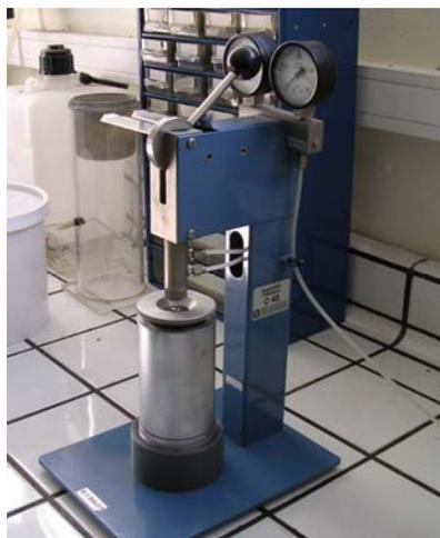
Le principe est d'utiliser une bombe calorimétrique (capacité d'environ 150 ml) comme récipient étanche permettant de travailler jusqu'à des pressions supérieures à 20 bars.
