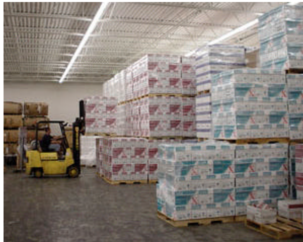
Figura 1.6 Apilamiento en el suelo.
