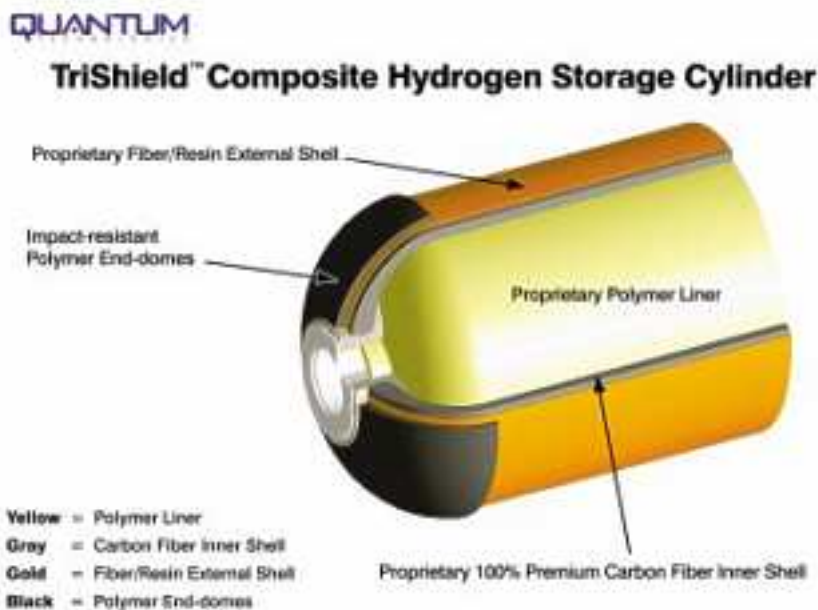
Figura 54 – Esquema de un tanque de hidrógeno comprimido.
