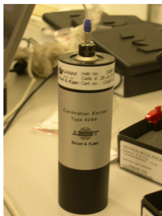
Figura 8.5 Excitador empleado para la calibración de los acelerómetros 256 HX-100.
