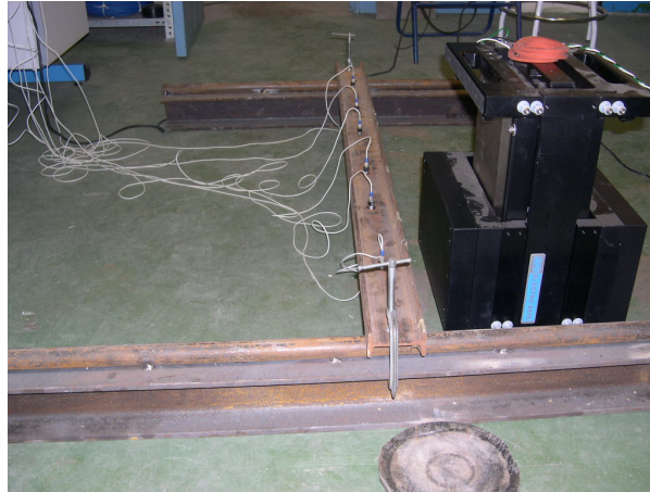
Figura 8.6 Ensayo de una perfil IPN-80 biapoyado.
