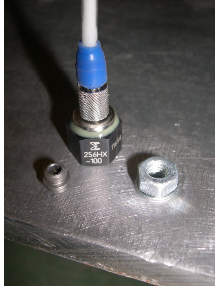
Figura 8.2 Elementos del sistema de fijación para el acelerómetro 256 HX-100.
