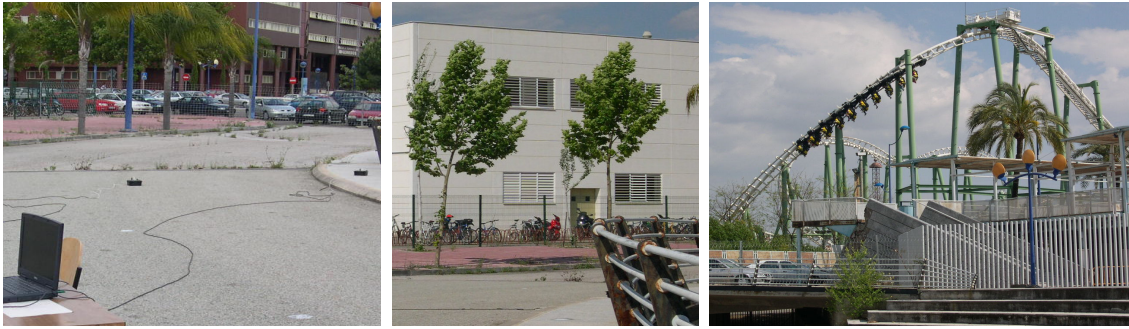
Figura 8.48 Excitaciones de la estructura: tráfico, viento y atracciones de un parque temático cercano.
