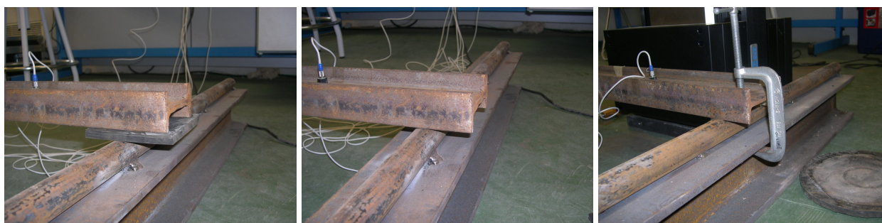
Figura 8.17 Fotografías de las tres condiciones de contorno ensayadas.
