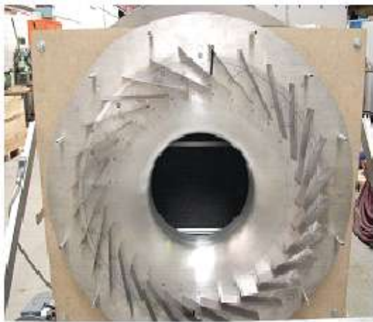
Fig. 3.4.1.2: Vista de los álabes con el rotor Desmontado
