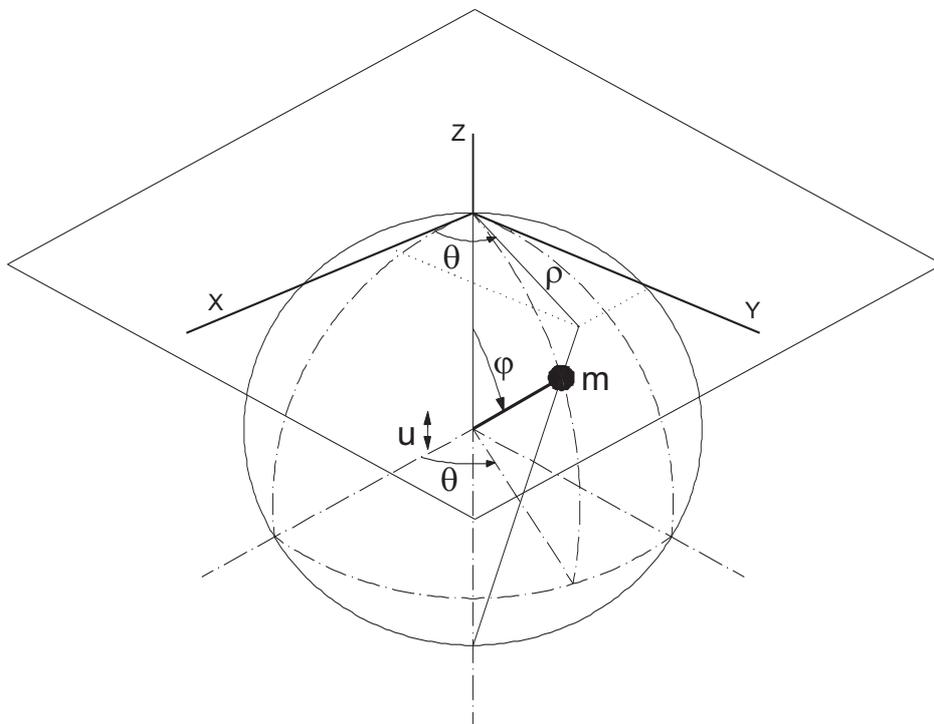
Figura 2.4: Coordenadas estereográficas polares.
