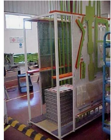
**Figura 3 - 30 Carro de aprovisionamiento de piezas H/Stab Skinning.**
