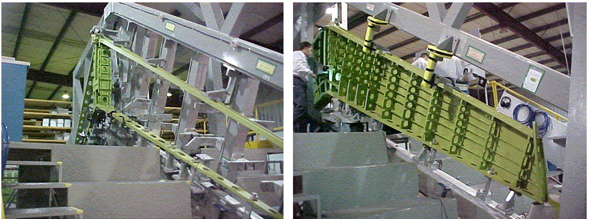
Figura 3 - 18 Gradas de los puestos de trabajo H/Stab Structure y H/Stab Skinning.
