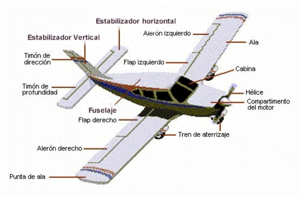
Figura 3 - 1 Estructura de un avión.
