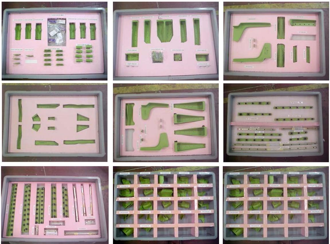
Figura 3 - 31 Cajas de piezas en carro de aprovisionamiento H/Stab Skinning.
