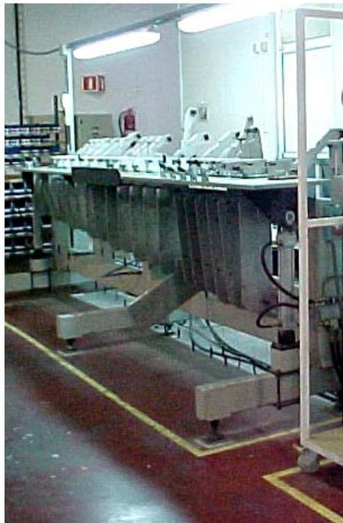
formar la estructura. Después se pasará al taladrado y unión de los distintos elementos. Con ellos estamos garantizando que cada pieza va a la posición que debe de ir, por tanto tendremos unas referencias fijas que nos fija la pieza en el espacio y la posición relativa de los distintos elementos respecto a dicha posición tomada como referencia.
