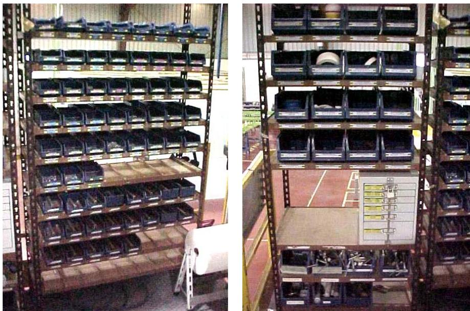
**Figura 3 - 22 Ubicaciones para comerciales, consumibles y herramientas de corte en estanterías normalizado para el puesto H/Stab Structure**
