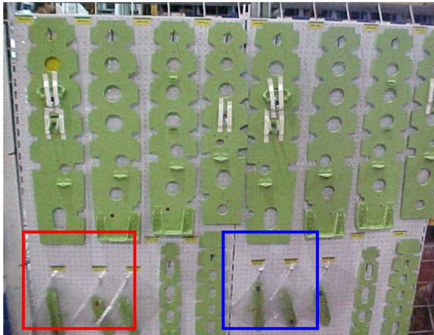
**Figura 3 - 38** Paneles para subconjuntos en proceso de H/Stab Central Center para H/Stab Structure
