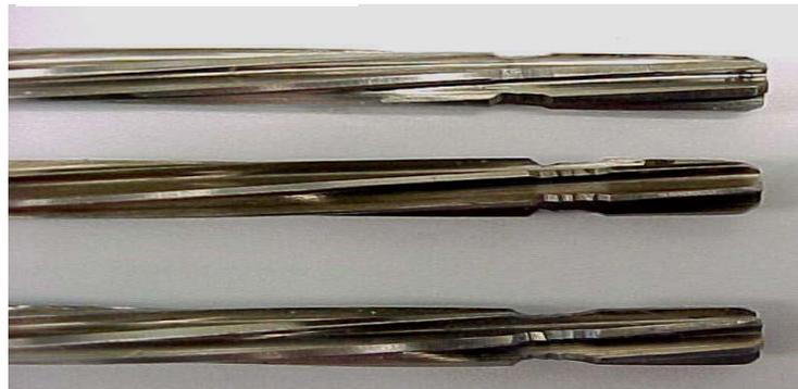
Mellas y desprendimientos de material en filos de corte y en guía.
