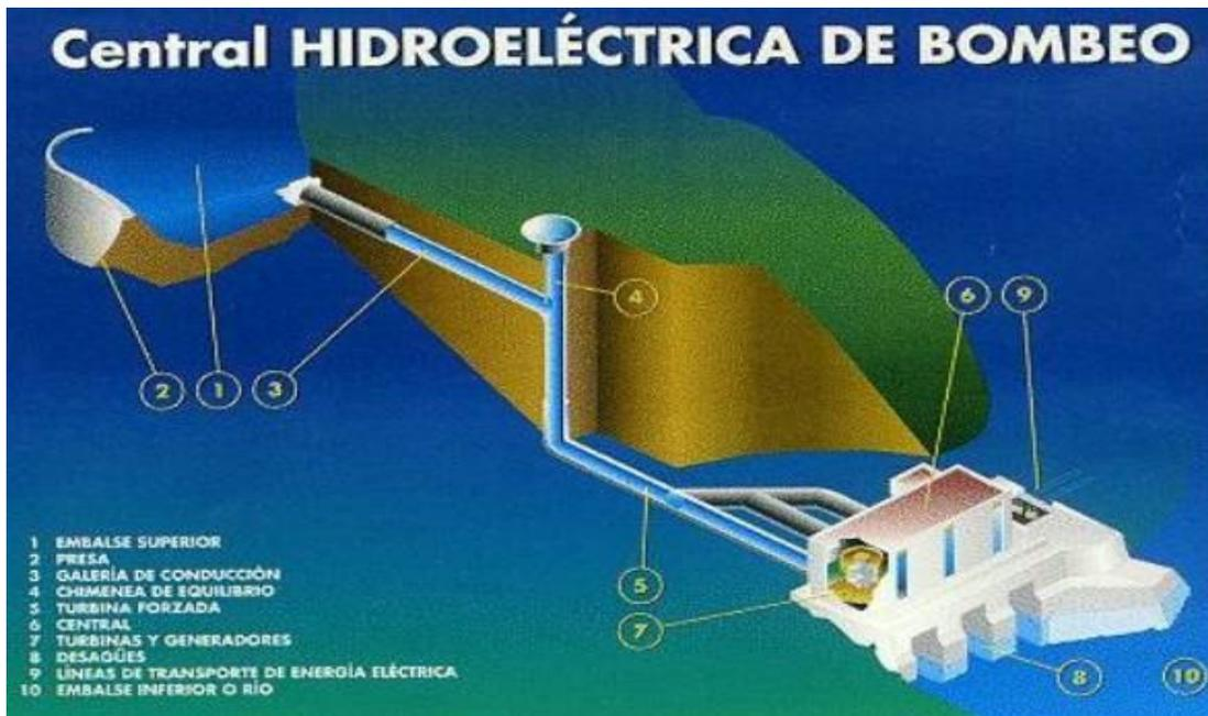
**Figura 3. Esquema de funcionamiento de una central de bombeo.**
