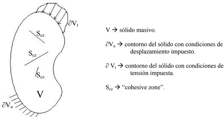
fig. 54 : esquema la implementación de una “cohesive zone” en un sólido arbitrario.
