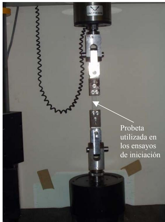
fig. 30 : vista del montaje experimental para la determinación de la tensión crítica.
