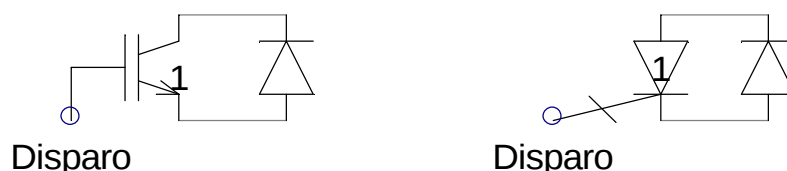
Ilustración 12. Transistor (a) IGBT y (b) GTO con su diodo en antiparalelo.
