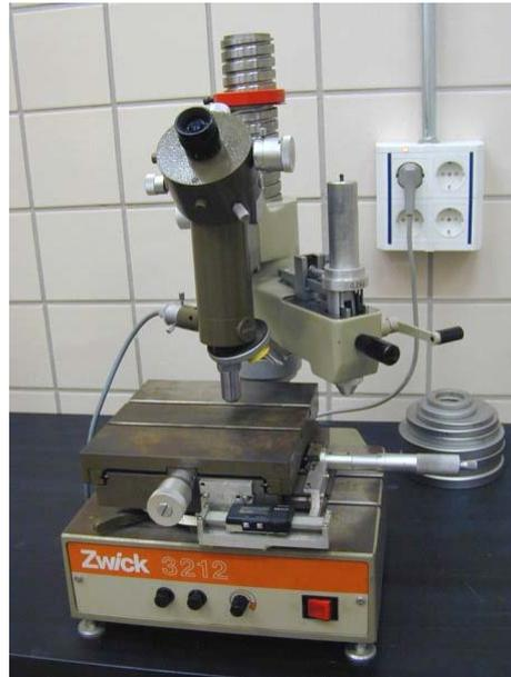
Figura 3.6 Microdurómetro
