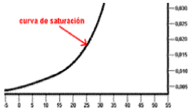
Figura 2.34: Situación de la curva de saturación en el diagrama psicométrico.
