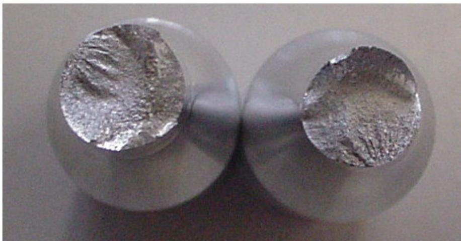
Fig. 3-2. Superficie de rotura por fatiga.
