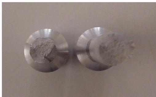
Fig. 5.2.1-6. Probeta rota durante ensayo de tracción, vista frontal.
