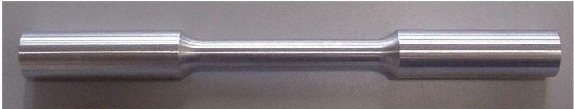
Fig. 5.1-2. Fotografía de una probeta de ensayo de tracción.
