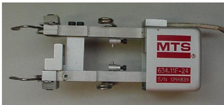
Fig. 5.2.1-2 : Extensómetro empleado en la realización de ensayos de tracción.
