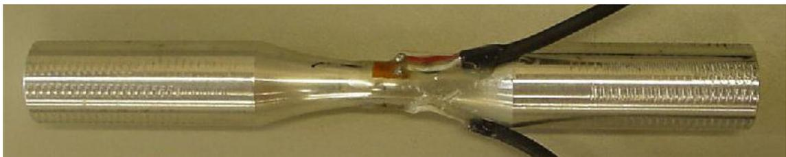
Fig. 5.1-4. Fotografía de una probeta de ensayos de vida a fatiga.
