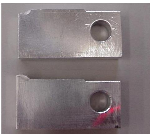
Fig 5.2.3-11. Probeta rota tras ensayo de crecimiento de grieta, vista lateral
