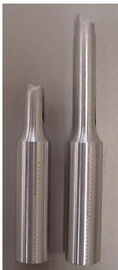
Fig. 5.2.1-5. Probeta rota durante ensayo de tracción, vista lateral.
