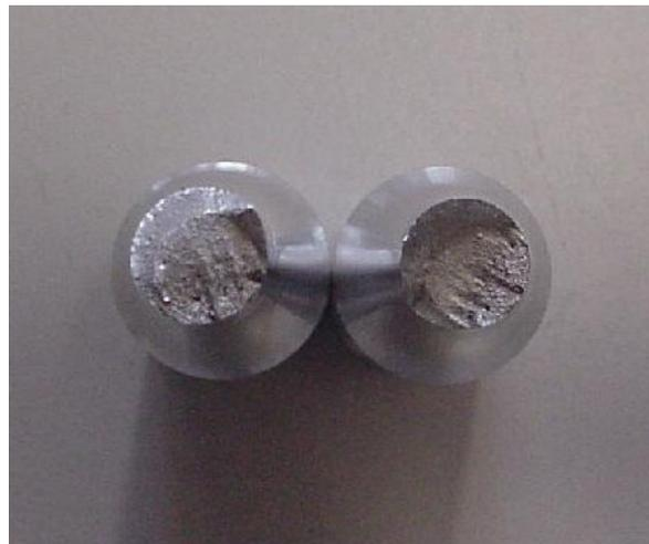
Fig. 5.2.2-5. Probeta rota durante un ensayo de vida a fatiga, vista frontal.
