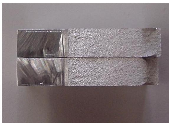
Fig 5.2.3-12. Probeta rota tras ensayo de crecimiento de grieta, vista frontal.
