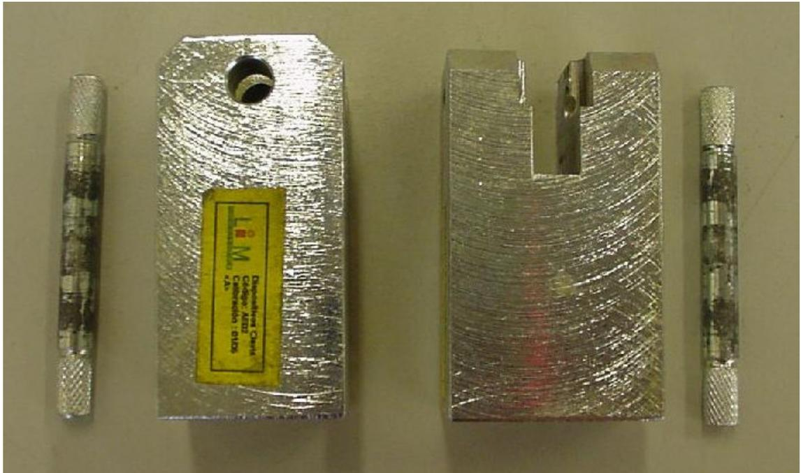
Fig. 5.1-7. Clevis empleado en los ensayos de crecimiento de grieta.
