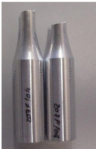
Fig. 5.2.2-4. Probeta rota durante un ensayo de vida a fatiga, vista lateral.
