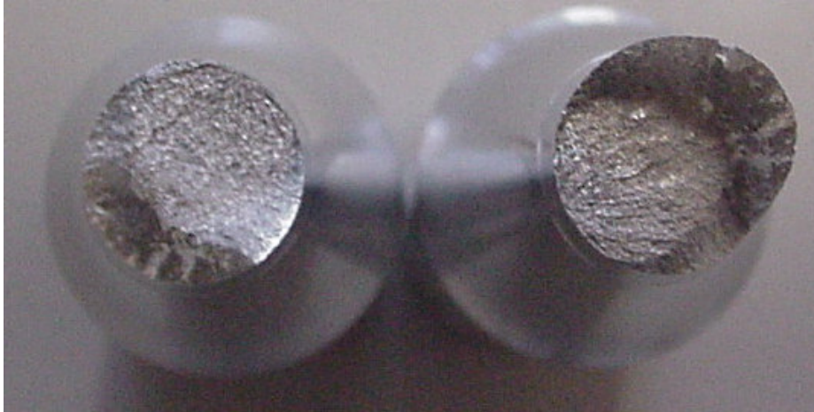
Fig. 6.2-1. Superficie de rotura de la probeta 199F-04 (173 MPa Aplicados).
