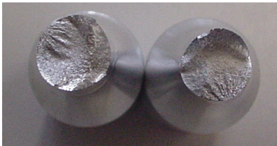
Fig. 6.2-2. Superficie de rotura de la probeta 208F-04 (236 MPa Aplicados).
