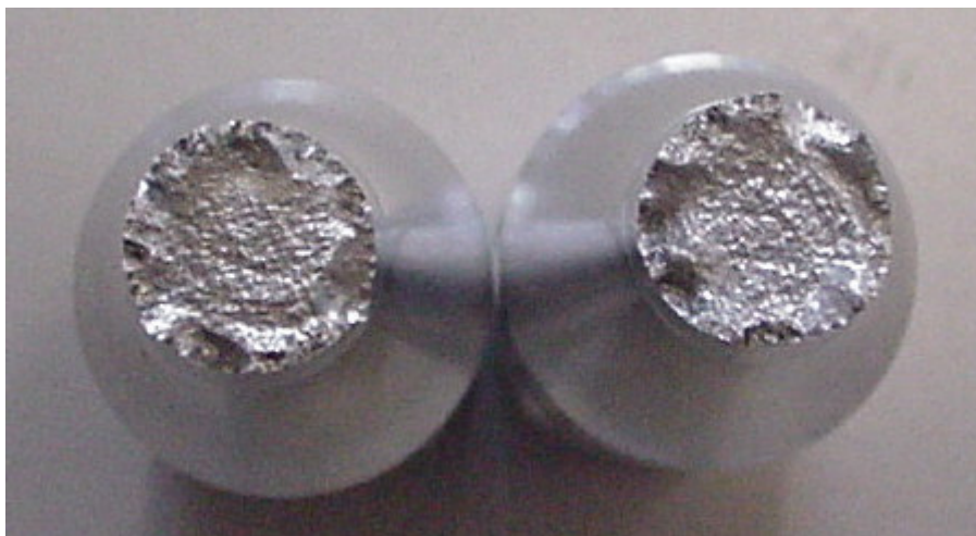
Fig. 6.2-4. Superficie de rotura de la probeta 193F-04 (393 MPa Aplicados).
