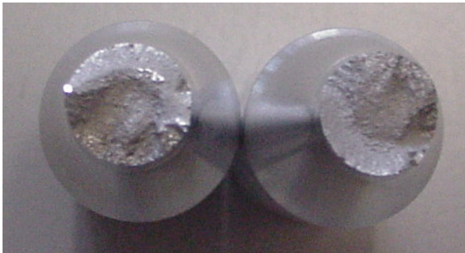
Fig. 6.2-3. Superficie de rotura de la probeta 179F-04 (314 MPa Aplicados).
