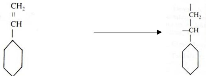
La apertura del doble enlace del ácido maleico permite la unión con los grupos estireno. Ello origina la reticulación (unión) de cadenas poliéster, unas con otras, a través de los grupos monómeros del estireno de la forma que se indica a continuación y que corresponde a la estructura química del **Poliéster Isoftálico**.
