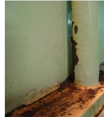
4. Recubrimiento de equipos en atmósferas agresivas
