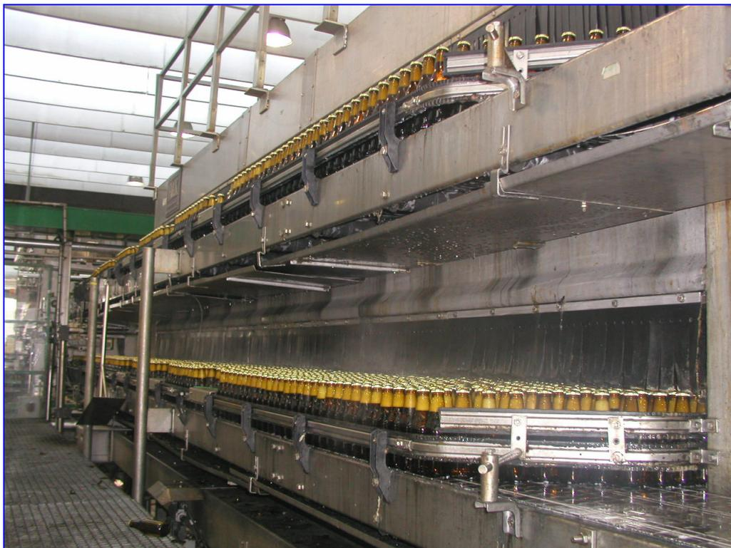
Imagen 11. Pasteurizador Tunel de Botellas
