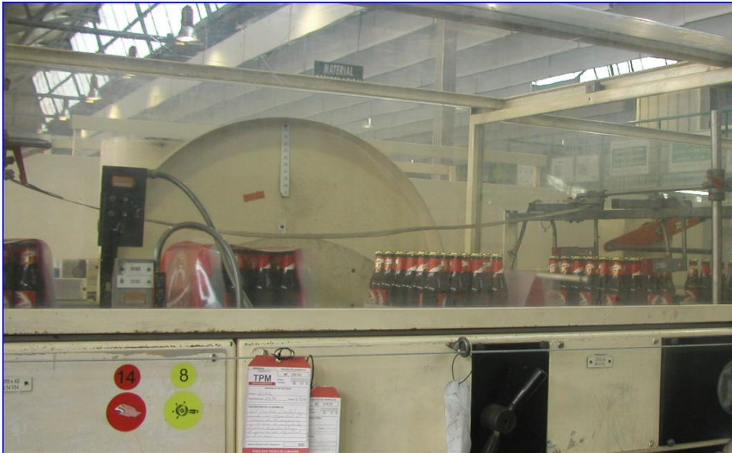
Imagen 18. Empaquetadora Kisters – Sistema envolvente
