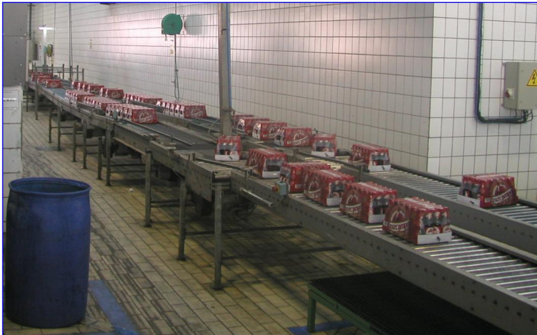
Imagen 20. Transportes de rodillos dirección paletizadoras de botellas
