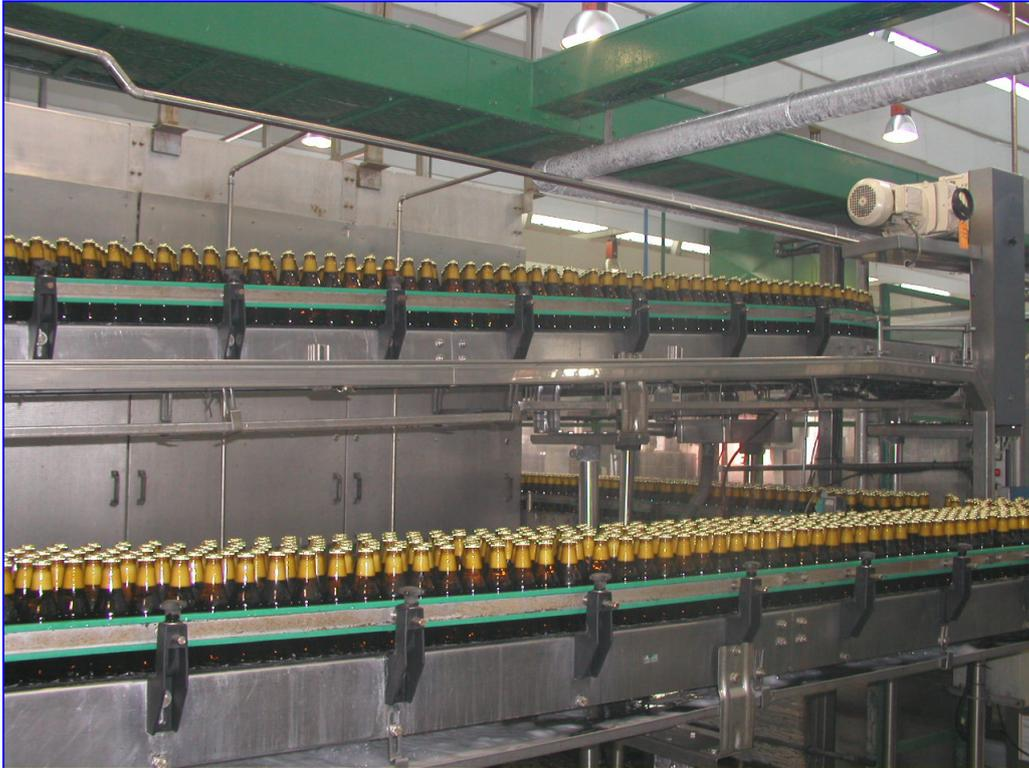
Imagen 10. Transportadores LLenadora a Pasteurizador
