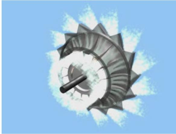
Fig. 2.154. Compresor centrífugo.
