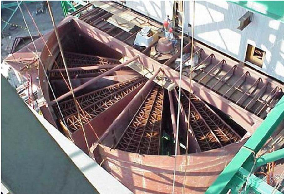
Fig. 2.14. Regenerador rotativo
