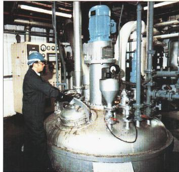
Fig. 3.45. Parte superior de un reactor y el motor de agitación.
