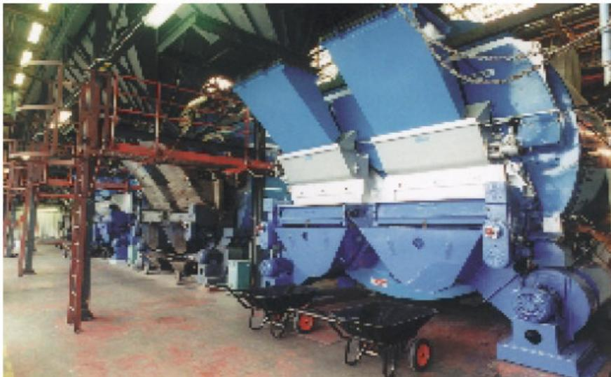
Fig.3.2. Caldera con cortafuegos (primer plano), y sin cortafuegos (segundo plano).
