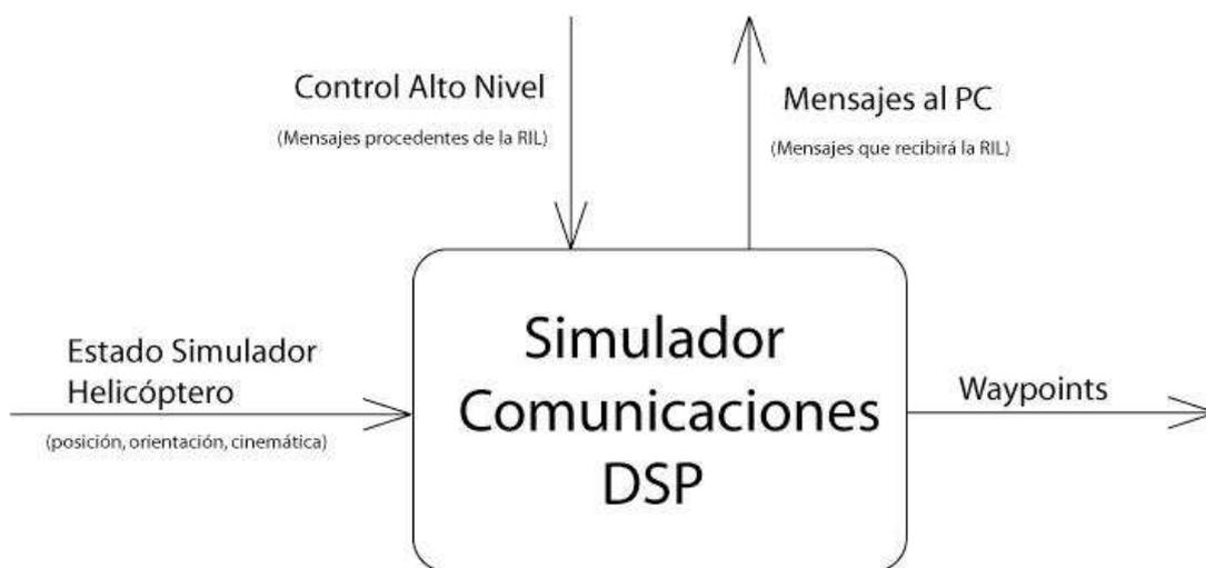
Figura 2.8-1: Simulador de las comunicaciones del DSP
