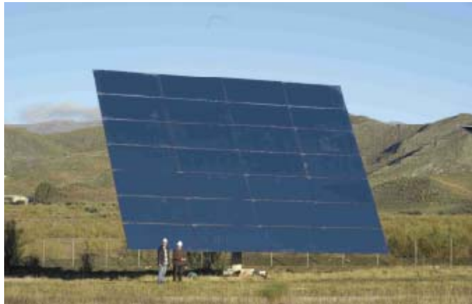
Figura 2.3- Heliostato de 120 m 2 diseñado por Solúcar S.A. para la planta PS10
