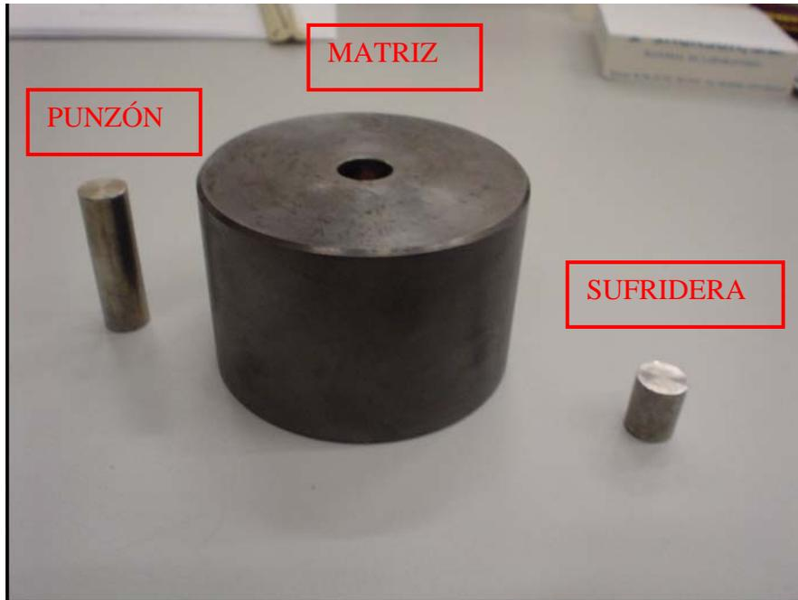
**Figura 3.12** *Matriz, sufridera y punzón para ensayo de termofluencia*
