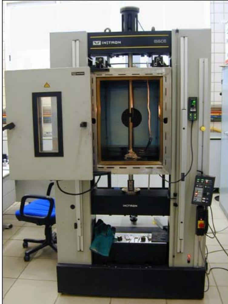
**Figura 3.2** *Máquina dinámica Instron 5505*
