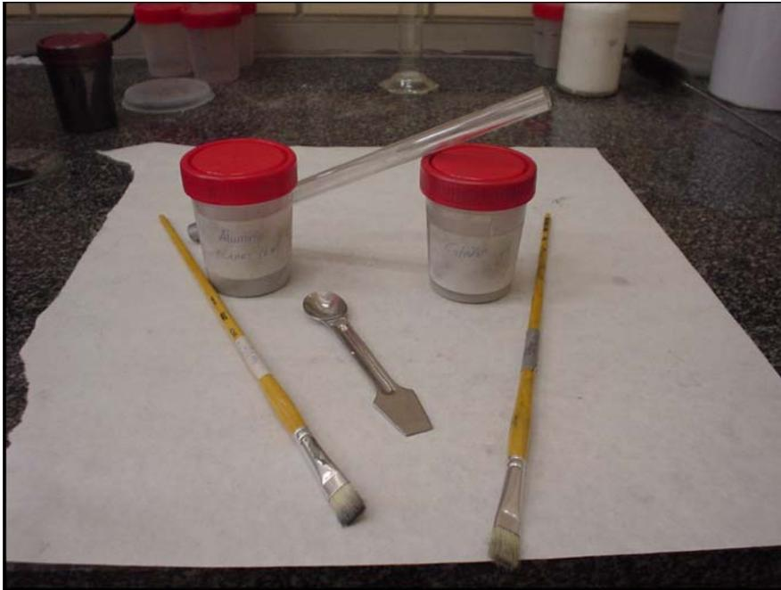
Figura 3.1. Toma de muestras del Al (tubo de vidrio) y Sn y Pb (cucharilla)
