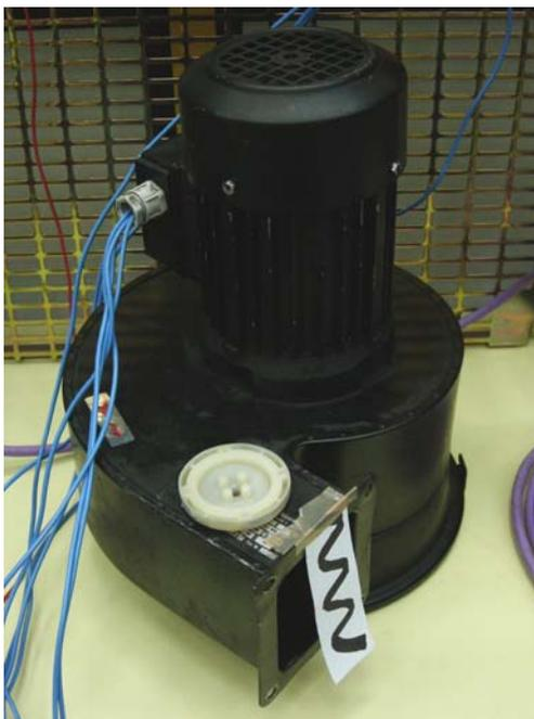
**Figura 5.17 - conjunto motor - ventilador centrífugo**
