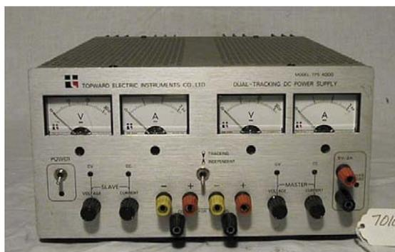
**Figura 5.23 - Fuente de tensión CC variable**
