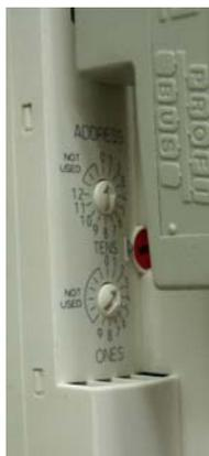
Figura 6.11 - diales de selección de dirección del módulo E/S Advantys
