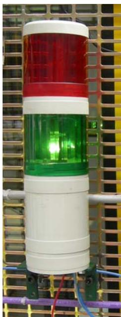
5-1 - columna de señalización de dos módulos
