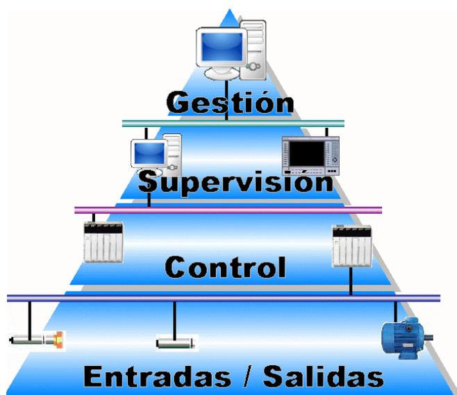
Figura 1.2 – Niveles CIM de los sistemas de comunicación industriales
