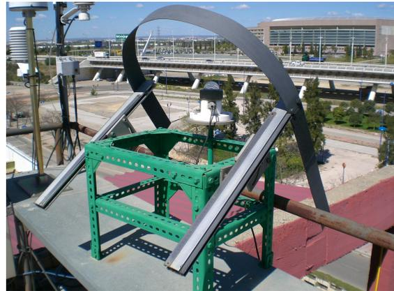
Figura 4.3 Piranómetro Middleton SK01-D con banda de sombra
