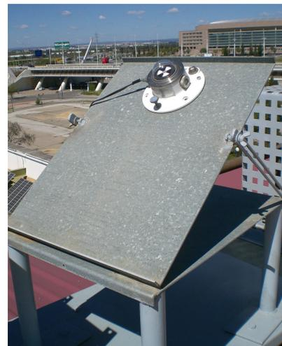
Figura 4.2 Piranómetro Eppley blanco y negro (Modelo 8-48) sobre superficie inclinada  $37^\circ$
