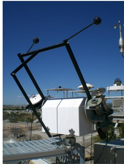
Figura 4.5 Sun tracker de Sci-tec, modelo 2AP
