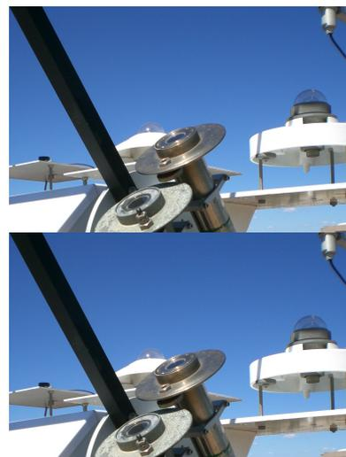
Figura 4.4 Pirheliómetro Eppley, modelo NIP
