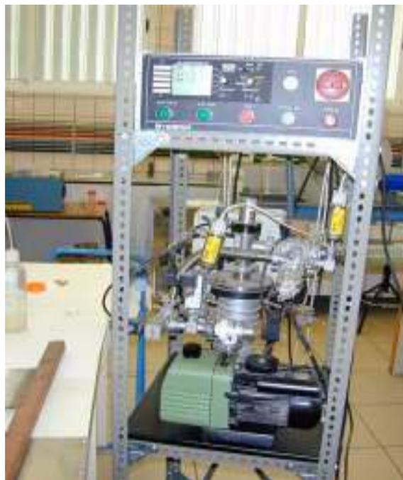
**Figura 10:** Equipo de vacío.
