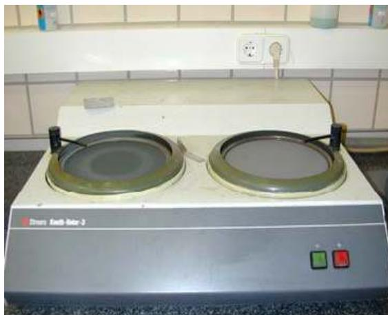
**Figura 14:** Equipo de desbaste y lijado.
