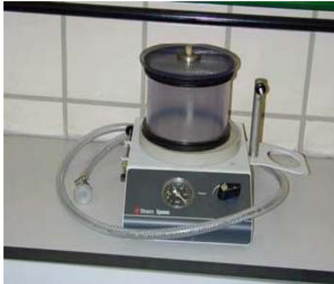
**Figura 11:** Cápsula de vacío.
