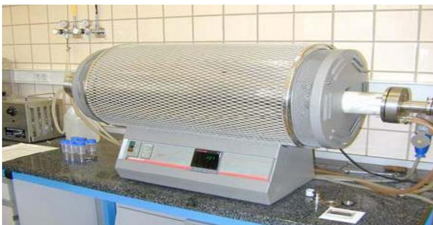
**Figura 9:** Horno cerámico de tubo horizontal CARBOLYTE tipo STF 15/75/450.
