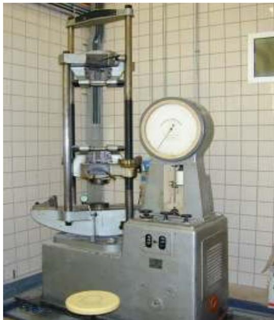
**Figura 6:** Máquina universal de ensayos MALICET ET BLIN U-30, con el montaje para realizar la curva de compresibilidad.
