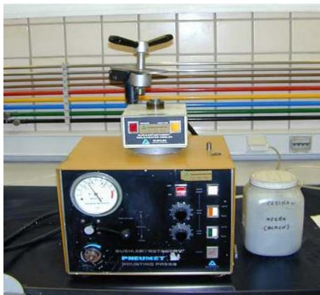
**Figura 13:** Máquina de empastillado
