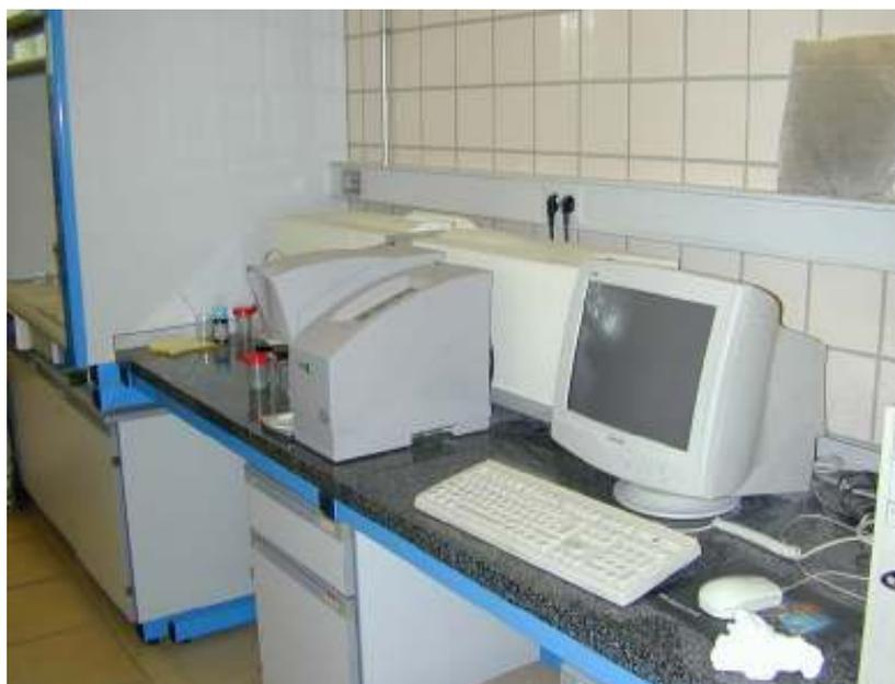
**Figura 3:** Mastersizer 2000, equipo para la medición del tamaño de las partículas de un polvo.
