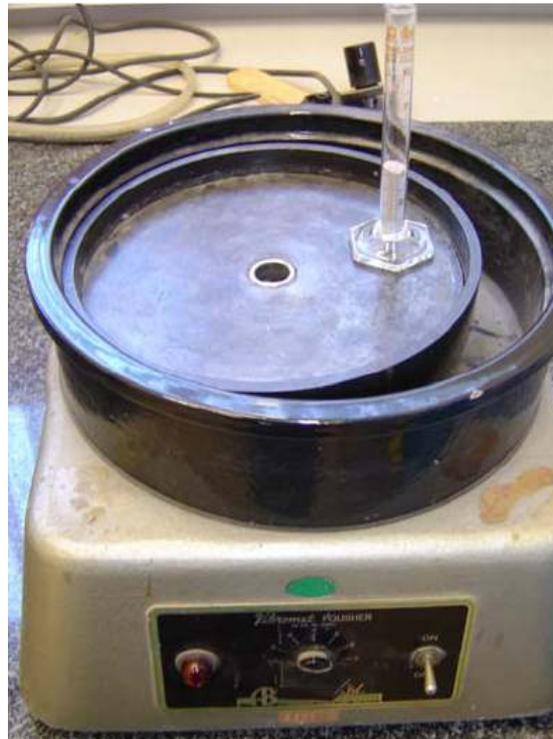
**Figura 2:** Pulidora vibradora y probeta graduada.
