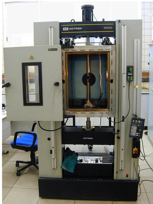
**Figura 17.** Máquina de Tracción Instron 5505.
