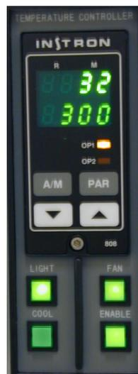
**Figura 19.** Control de temperatura del horno.
