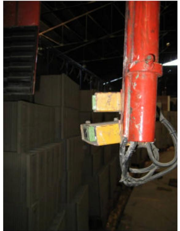
Transcurrido un tiempo la pinza sube y el puente se dirige hacia la posición de recogida de piezas.
