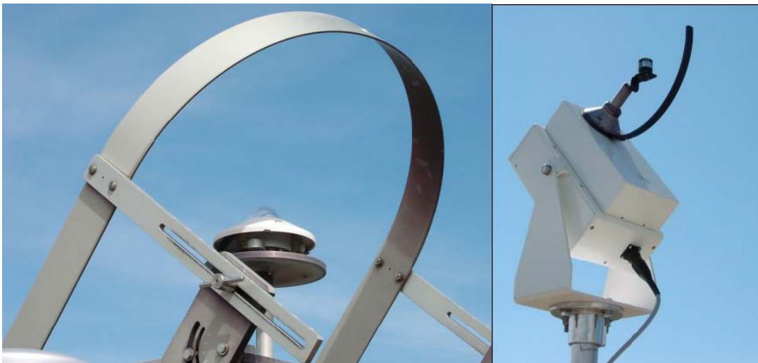
Figura 14. Ejemplos de piranómetros sombreados para medir la difusa
