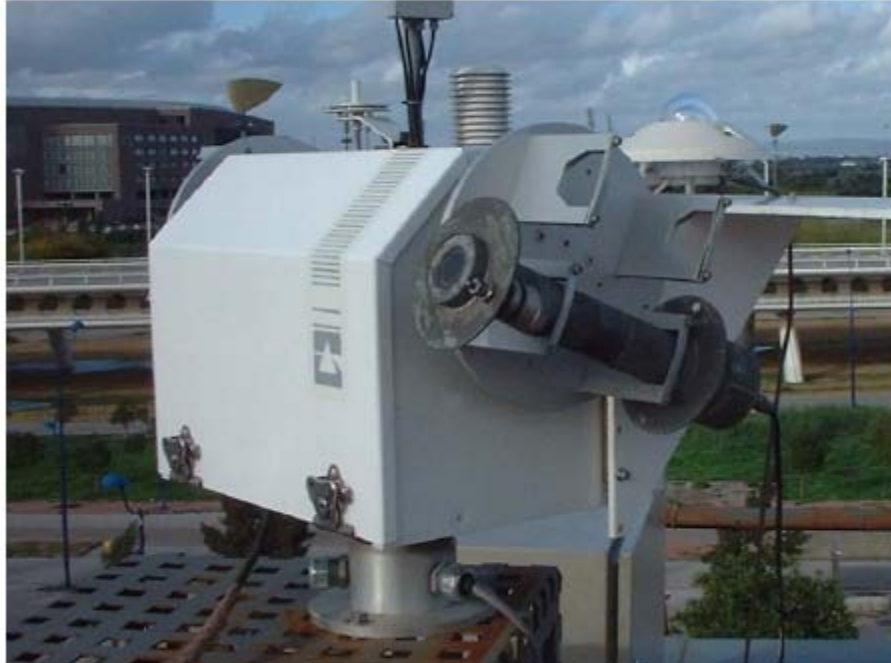
Figura 11. Pirheliómetro NIP montado sobre seguidor solar
