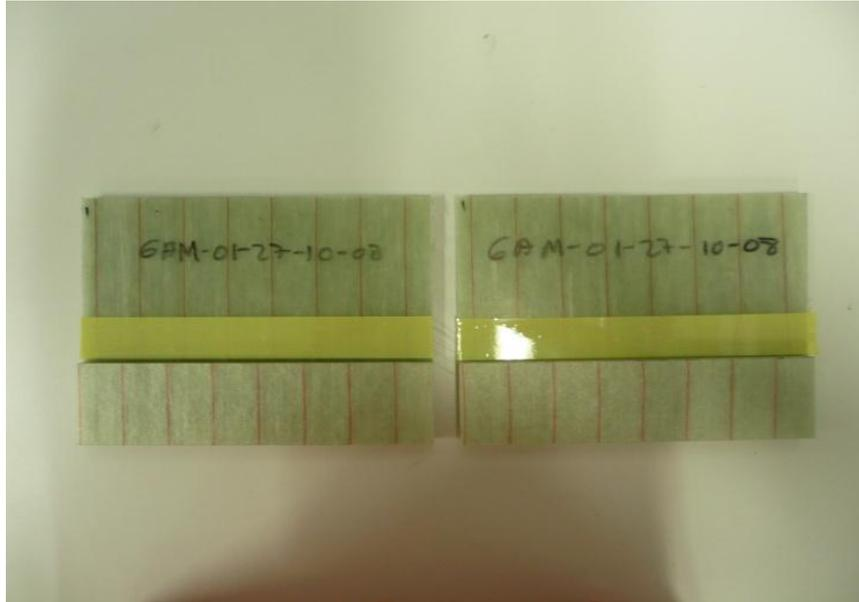
**Figura 17. Semi-paneles con los tacones pegados**
