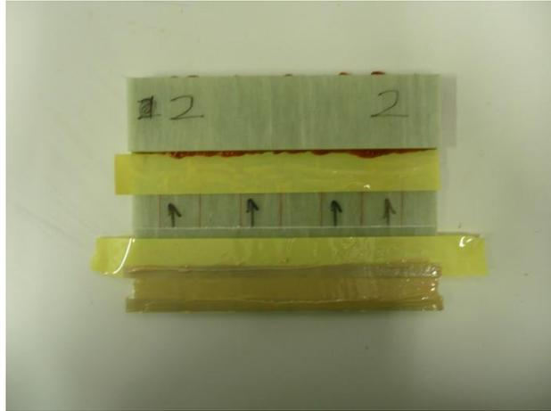
**Figura 22. Conjunto que se introduce en la cámara climática y se expone a ambiente húmedo**
