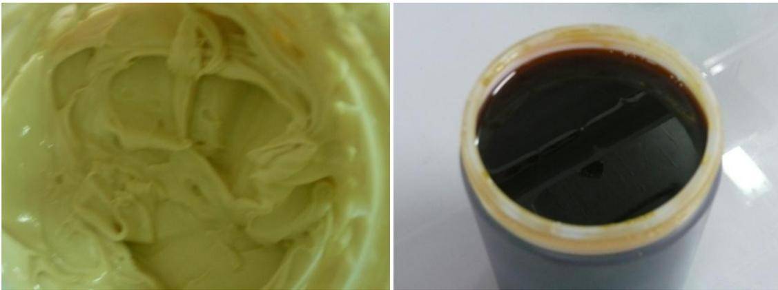
**Figura 14. Muestra de la base y del endurecedor, por ese orden**
