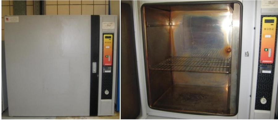
**Figura 25. Horno donde se curó el adhesivo**
