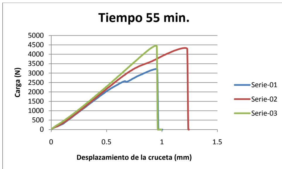
Gráfica 14. Diagramas Carga-desplazamiento de las probetas más representativas
