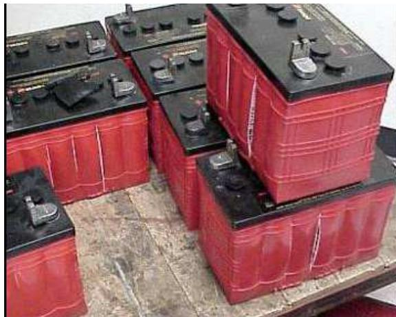
*Gráfica 2.1. La hinchazón y la separación de las celdas originan derrames de ácido y emisiones de gases inflamables [19].*
