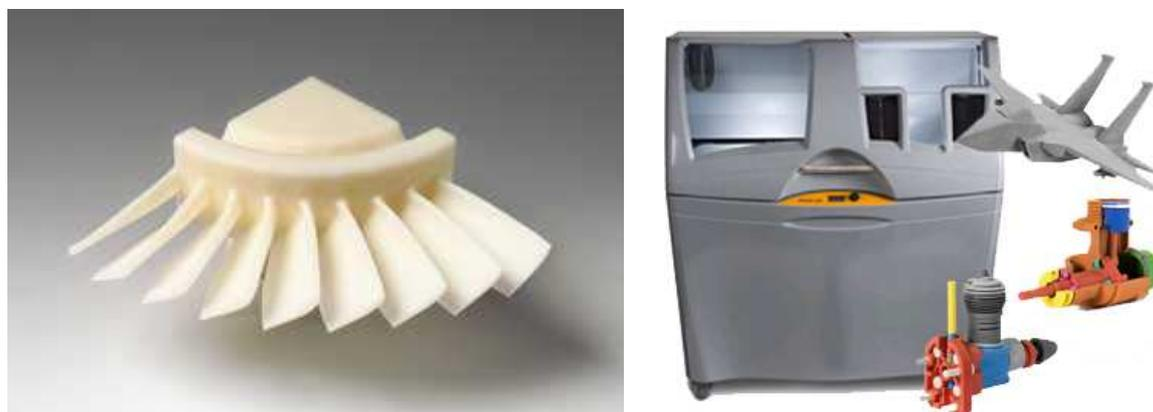
Figura 75.- Equipo Estereolitográfico y copia 3D de  $\frac{1}{4}$  de corona de álabes de una turbina de gas.
