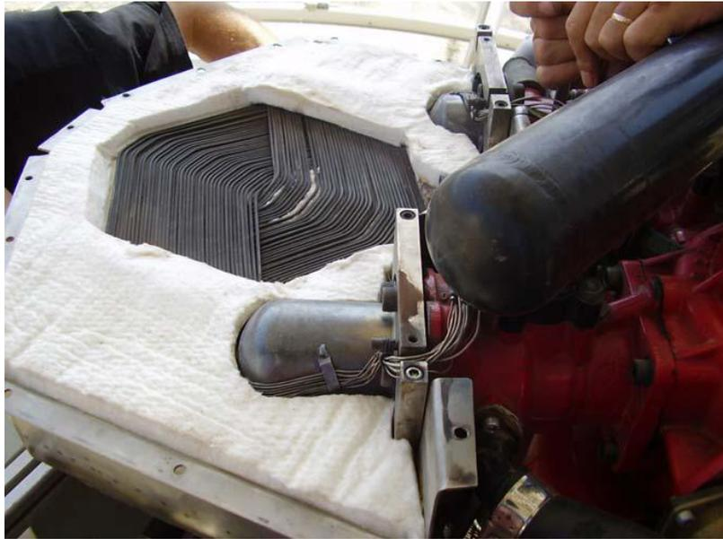
Figura 23. Receptor de sistema EuroDish
