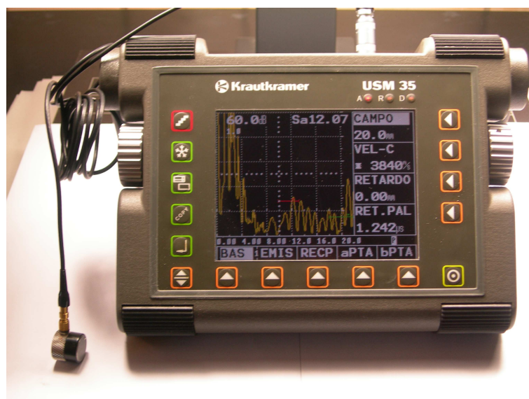
Figura IV - 4 Equipo de ultrasonidos KRAUTKRAMER USM 35
