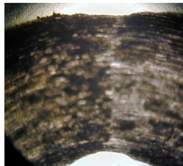
Figura V - 5 Imagen por microscopía óptica de Al-AM-60min para ensayos continuos de 1Km a 2N de carga
